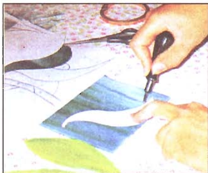
Контуры заготовки размечают по шаблону с помощью фломастера, предназначенного для нанесения надписей на стекле.
