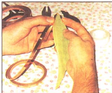
Вырезанные из цветного стекла детали окантовывают по всему периметру лентой из отожженной мягкой меди.
