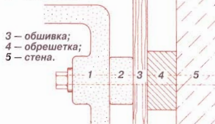
Рис. 7. Крепление умывальника: 1 — настенный умывальник; 2 — прокладка;
