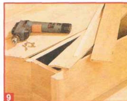
9 В доске задней стенка обязательно просверлить отверстия под шурупы.
