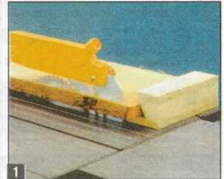
При обрезке досок на настольной дисковой пиле с направляющим пазом желательно пользоваться самодельным противовыбрасывателем (см. рис. 1).
