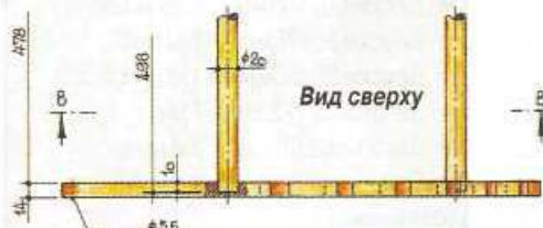
Рис. 6. Выдвижная полочка. По обозначенным осям отверстий выполняют соединения деталей с рамой и механизмом регулирования.
