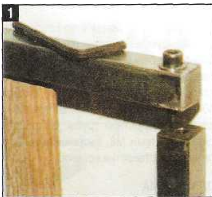
1 Направляющую раму можно сделать сборно-разборной, если собрать ее на винтах, используя вставки-бобышки с резьбовыми отверстиями.
