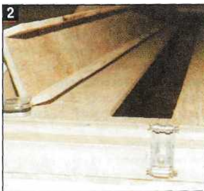
2 Защитный короб одновременно служит для сбора опилок. Сверху расположена рамка с роликами под шнур противовеса.
