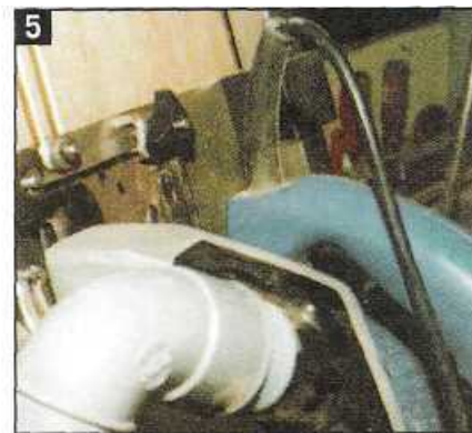
5 Пила закреплена на тележке при помощи скоб винтами и гайками-барашками. Через ролик на верхнем краю тележки перекинут шнур противовеса.
