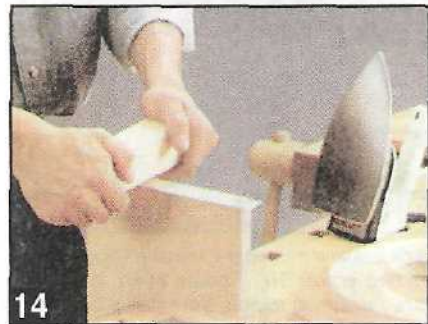
Кромки лицевых панелей выдвижных ящиков оклеивают узкими полосками букового шпона, приглаживая их горячим утюгом. Пока клей-расплав охлаждается, шпон следует плотно прижимать к поверхности кромки.
