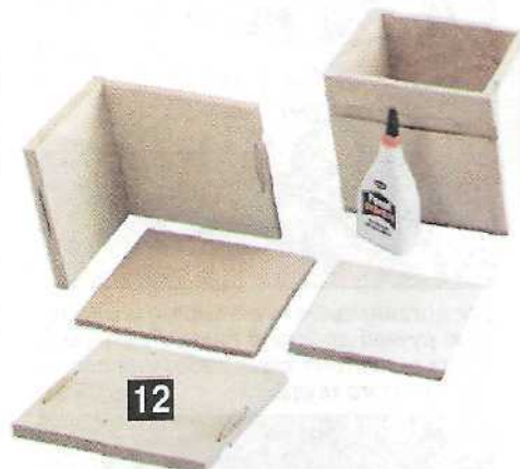
Детали выдвижных ящиков соединяют друг с другом на плоских шпонках с клеем. Днища прикрепляют снизу шурупами.
