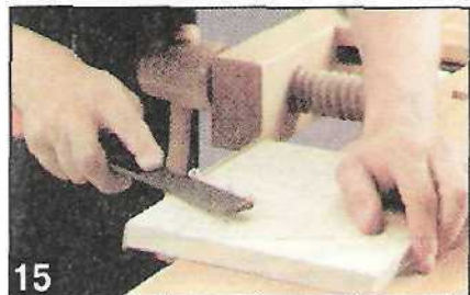
Свесы наклеенного шпона удаляют плоским напильником (но не стамеской!).
