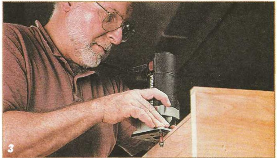
Рис. 3. Соединение деталей дверки. За счет вклейки фальцованных панелей в пазы планок обрамления получается очень прочная конструкция.
