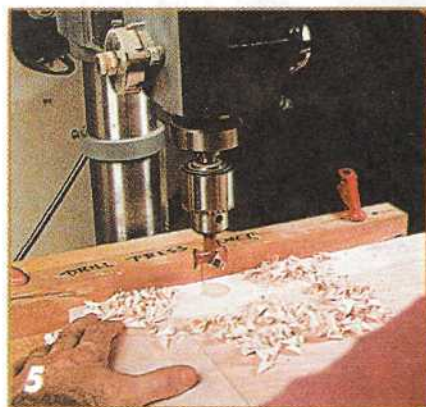
5 Сверление глухих отверстий в дверках для «чашек» петель лучше выполнить на стационарном сверлильном станке.
