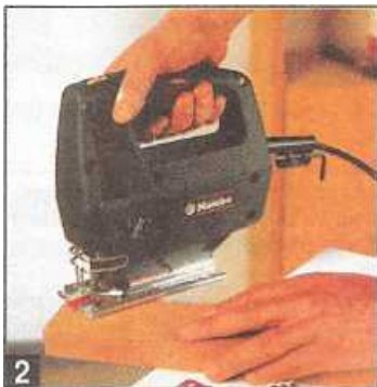
2 Кромки деталей закругляют элек- тролобзиком.
