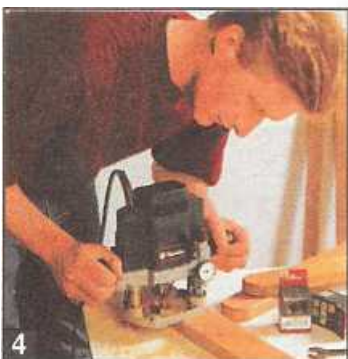
4 Все открытые кромки деталей притупляют фрезерной машинкой.
