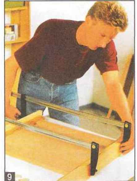
9 ... устанавливают боковые стойки и временно, пока не высохнет клей, скрепляют их струбцинами с деталью сиденья.
