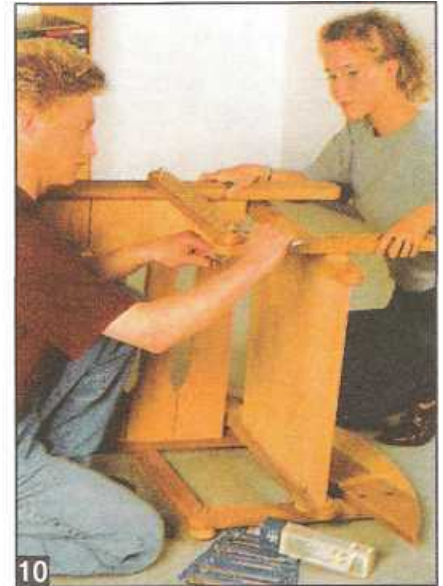
10 Подлокотники крепят на болтах с гайками,
