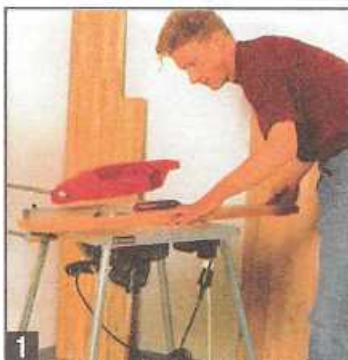
1 Все детали кресла раскраивают помощью настольной дисковой пилы.
