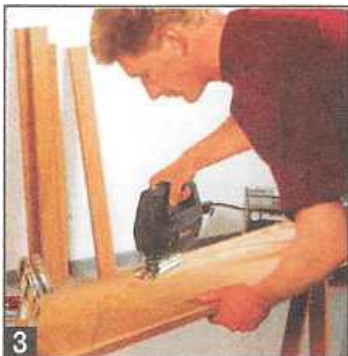
3 Полозья вырезают по заранее на- меченным контурам.
