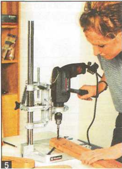
5 Закрепленная на сверлильной стойке электродрель обеспечивает строго вертикальное сверление отверстий.
