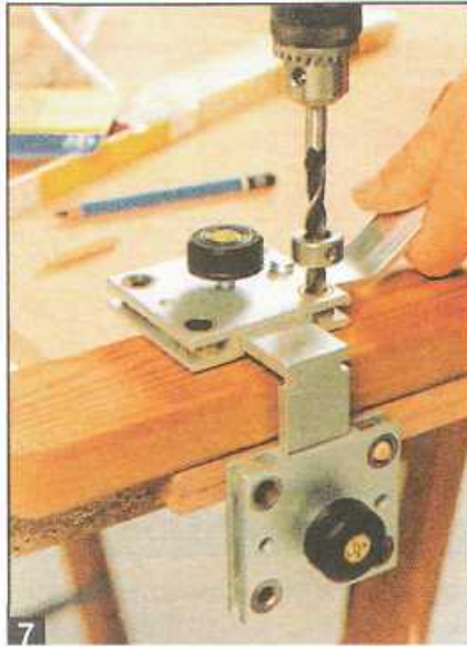
7 Специальный ограничитель, закрепленный на сверле, обеспечивает необходимую глубину отверстий.
