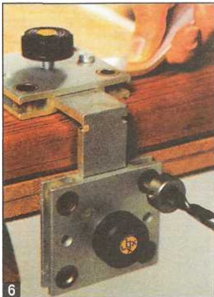
6 Сверлильный кондуктор позволяет точно просверлить отверстия под шканты.
