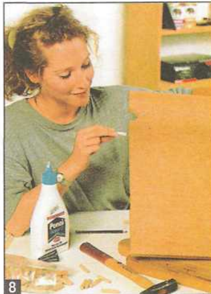
8 На водостойком клее вставляют шканты в отверстия сиденья. Затем...
