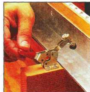
Эксцентриковые зажимы позволяют легко и быстро изменить положение суппортов и направляющей линейки.
