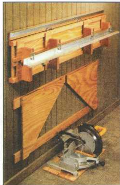
После окончания работы основание станка подвешивают на стену, а кронштейны поворачивают к стене.
