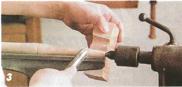
Шаблон для шипа. Для проверки диаметра и конусности используют шаблон из обрезка сосны.
