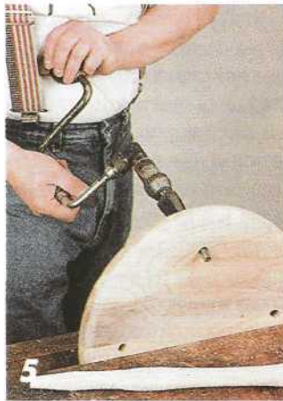
Развертывание отверстия. Закрепив сиденье в верстаке вертикально, отверстие разделяют конусной разверткой, зажатой в коловороте.
