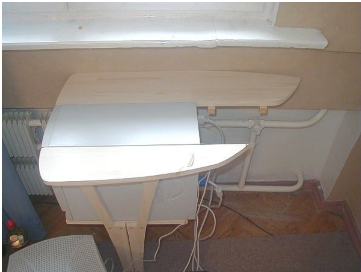
Вид сверху на вставленный в столешницу системный блок
