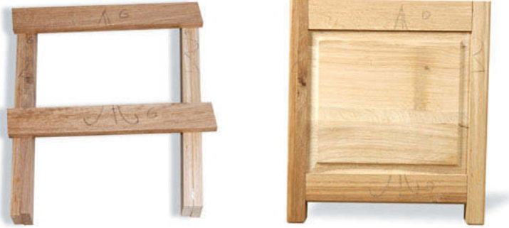
Côté du coffre. Pièces établies après corroyage, puis côté terminé.
