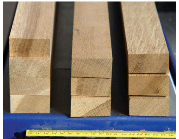
Rabotage en épaisseur. Les pièces doivent être accessibles et placées face ou chant devant être raboté orienté vers le haut pour la passe suivante.
