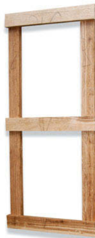
Dessus du coffre. Pièces établies après corroyage, puis dessus terminé.
