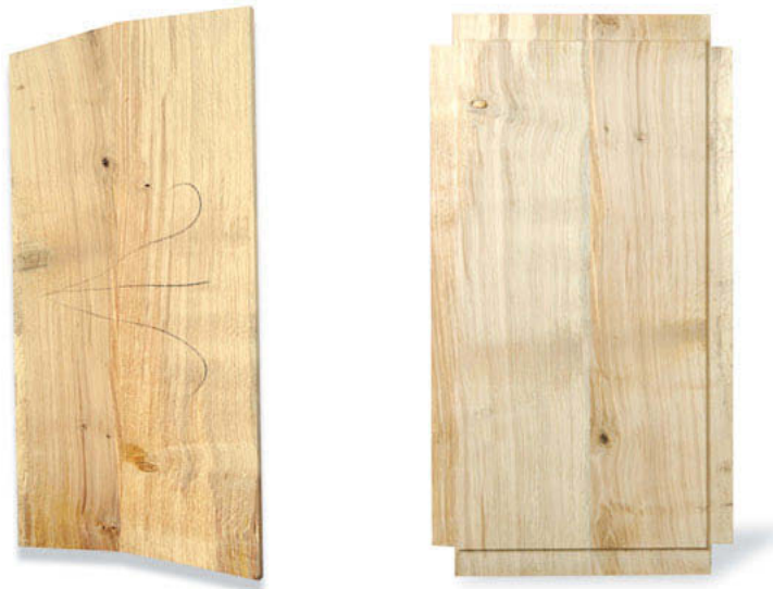
Fond du coffre. Pièces établies après corroyage, puis fond terminé.
