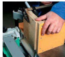
Usinage d'un assemblage par tourillons.
