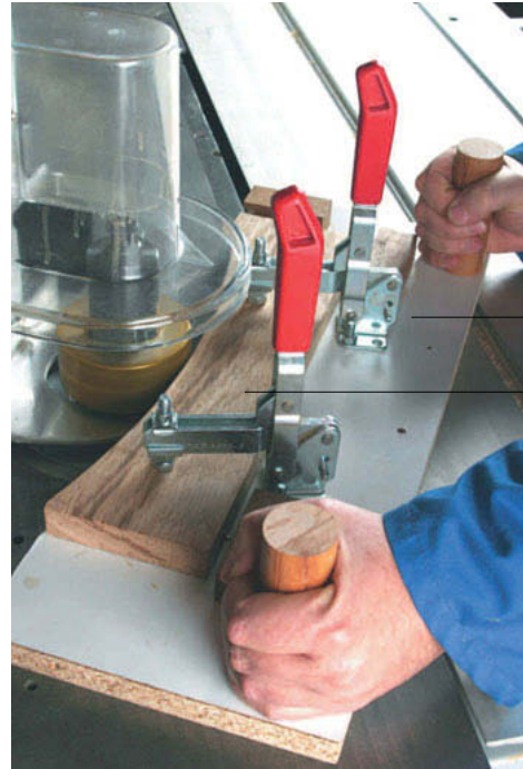
Ce montage permet de réaliser des traverses cintrées.
