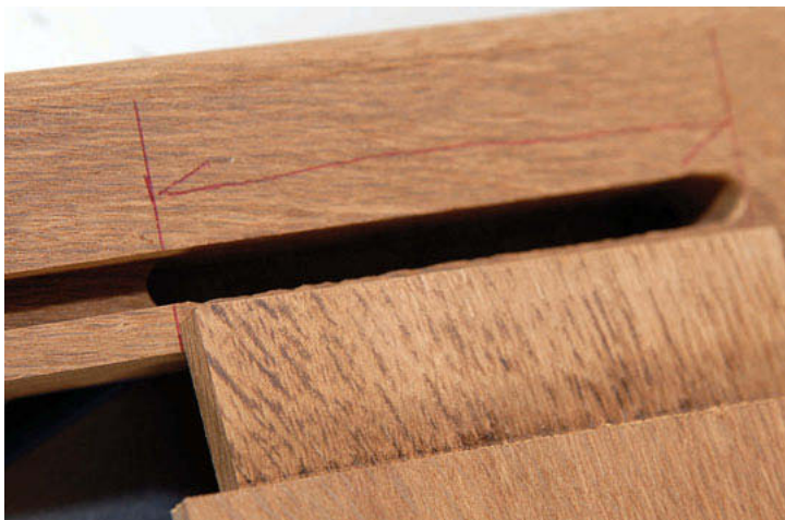
Traverse basse et pied du lit. Les rainures de la traverse basse du lit diminuent la largeur des tenons, donc la longueur de la mortaise.
