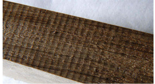
Oubli de ponçage mis en avant par le vernis.
