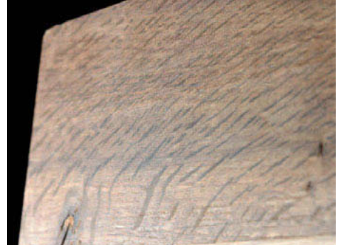
L'état de surface est correct, le fil du bois a été couché par l'outil.
