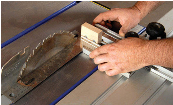
Réglage de l'équerrage de la règle de tronçonnage. Cette étape est essentielle pour obtenir un panneau d'équerre.
