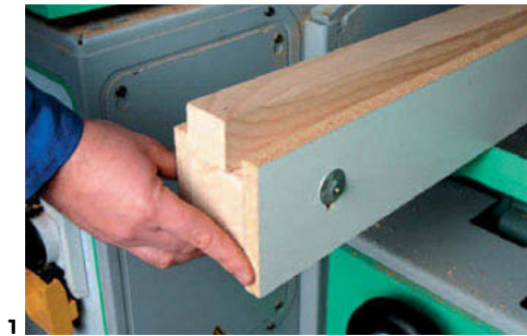
Usinage de la troisième face de la pièce (boulon en position haute). Pièce avant usinage (1) et après usinage (2).
