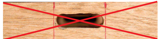
Mortaise incorrecte : l'assemblage sera impossible.
