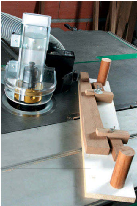
Ce montage permet de fabriquer des pieds gainés.
