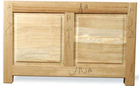
Arrière du coffre. Pièces établies après corroyage, puis arrière terminé.
