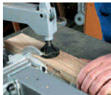
Les mortaises sont réalisées en effectuant une série de perçages...
