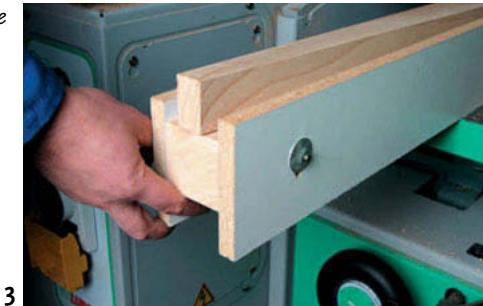
Usinage de la quatrième face de la pièce (boulon en position haute). Pièce avant usinage (3) et après usinage (4).
