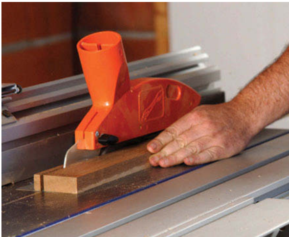
Fausse languette débitée dans une planche préalablement dégauchie et rabotée.
