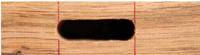
Mortaise respectant le tracé. L'assemblage sera solide.
