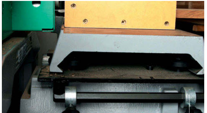
réglage de la butée pour le perçage des côtés
