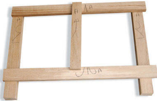
Arrière du coffre. Pièces établies après corroyage, puis arrière terminé.
