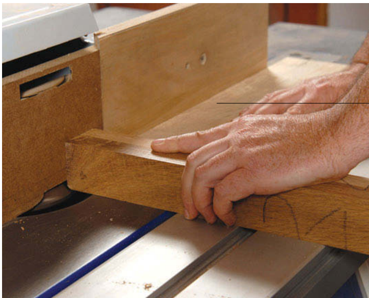
Toupillage à l'aide d'une plaque de guidage.
