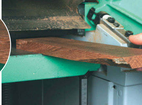
La pièce est mise dans le bon sens sur la table de la machine.
