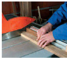
Tronçonnage de finition à la butée.
