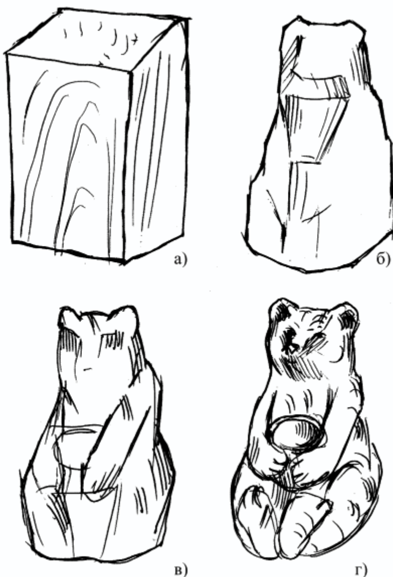
Рис. 47. Последовательность резьбы медведя: а – разметка; б – зарубка; в – черновая обработка; г – чистовая обработка и выжигание узора штампами
