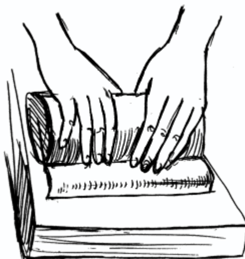
Рис. 19. Циклевание поверхности: а – цикля серийного производства; б – самодельная цикля (узкая и широкая) и положение рук при циклевании
